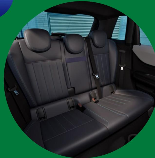
60:40分割可倒式リア・シートを倒せば、275リッターのラゲッジ・スペースが最大925リッターまで拡張。大きなサイズの荷物も積めて、もっと楽しめます。
