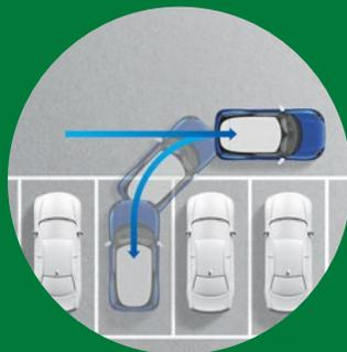
標準装備のパーキング・アシストが駐車スペースの候補を特定し、ボタンを押すだけで、選択した駐車スペースに誘導してくれます。
